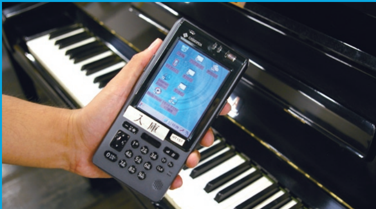
商品の流れを管理するPDA端末。基幹システムと無線LANで繋がっている。
